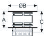
Regenkop Anti-Splash zonder draad + klemband
